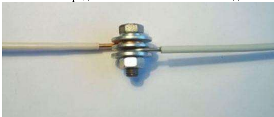
Рисунок 17 – Эталон порядка составления болтового соединения проводов
