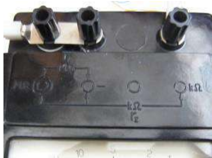
Рисунок 2 – Подключение для измерения кОм Рисунок 3 – Подключение для измерения МОм
