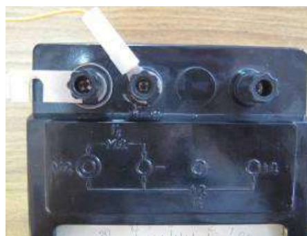
Рисунок 2 – Подключение для измерения кОм Рисунок 3 – Подключение для измерения МОм
